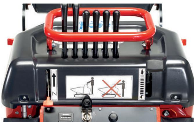
Il pannello di controllo è posto di fronte all'operatore, è confortevole e di facile utilizzo. Tutte le leve di comando sono facilmente raggiungibili e una maniglia offre all'operatore una presa sicura durante la guida.
